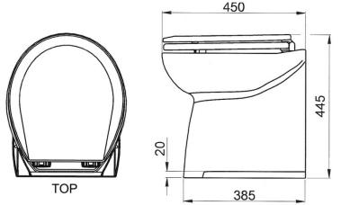
375 FLUSH WATER INLET Ø19 WASTE DISCHARGE Ø38
